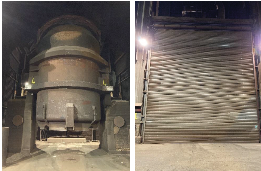
Figuur 6: Opstoken ruwizerpan Oxystaalfabriek
